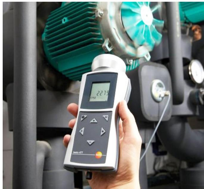
回転体・反復運動体の状態確認に testo 477 は、1秒間に0.5回から5,000回の間隔でLEDを照射し、回転運動や反復運動をしている物体の動きや状態を残像効果で観察するために使用します。印刷機の色ずれや織り機の糸送りむらがおきていないかの確認や、ギアのかみ合わせに異常がないかなどをスローまたはストップモーションで確認することができます。
